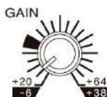
Para ajustar la ganancia de la señal de entrada. Para obtener el mejor equilibrio entre SNR y el rango dinámico, ajuste la ganancia de modo que el indicador PEAK se ilumine solo ocasional y brevemente en los transitorios de entrada más altos.
