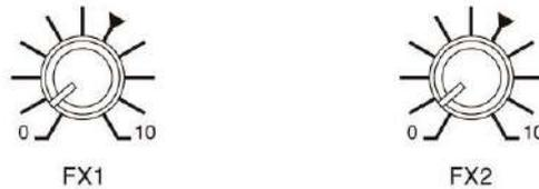
Para ajustar el nivel de las señales enviadas al efecto FX1 y FX2.
