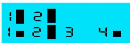
**NIVELES**, Muestra el nivel de señal presente en las entradas y salidas. Es la pantalla por defecto del dispositivo y a la que vuelve tras 10 segundos sin editar una pantalla. Junto a cada entrada/salida aparecerá una barra marcando el nivel de acuerdo con la tabla adjunta:
