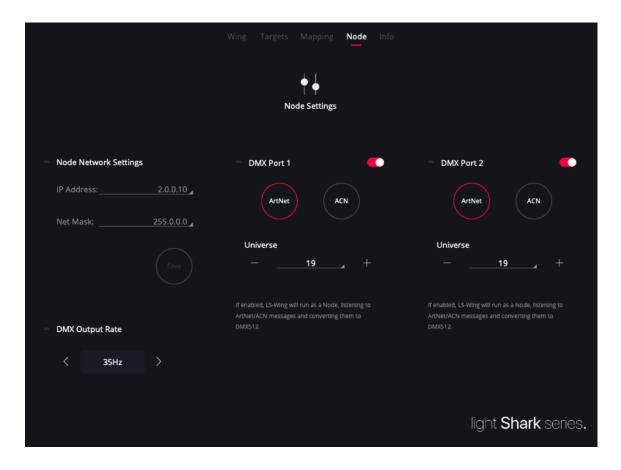
**DMX Port**, LS-Wing incluye un nodo de 2 universos completamente configurables de forma independiente. Cada uno de los universos puede tener un protocolo o universo diferente configurado.
