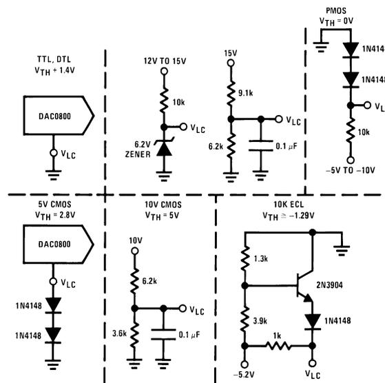
$V_{TH} = V_{LC} + 1.4V$
